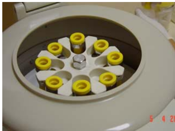
Figura 2A. Fixação dos frascos com as amostras de sangue no suporte próprio para suspensão na centrífuga;
